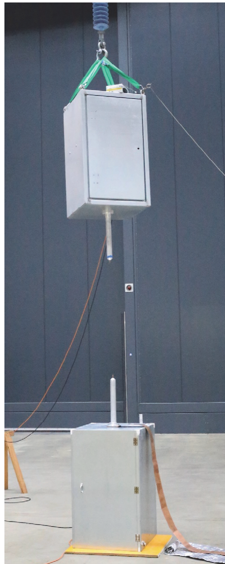
Abbildung 1: Messanordnung zur synchronen Erfassung der Vorentladeströme beidseitiger Elektroden
