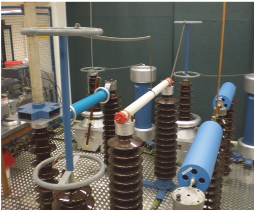
Abbildung: Prüfsystem zur Erzeugung von Wechselspannungen bis 200kV
