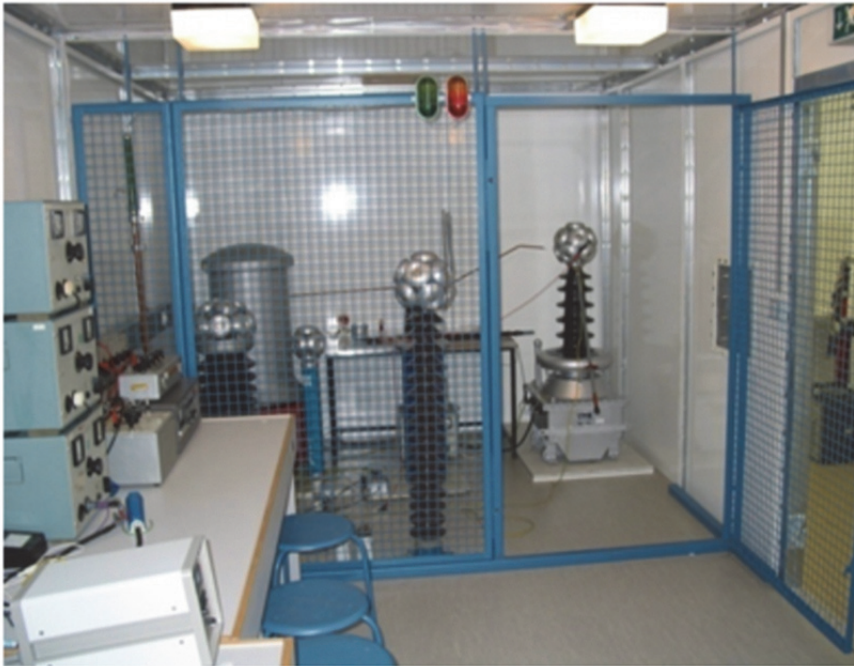
Abbildung: Geschirmte Messkabine zur Teilentladungs- und Verlustfaktormessung
